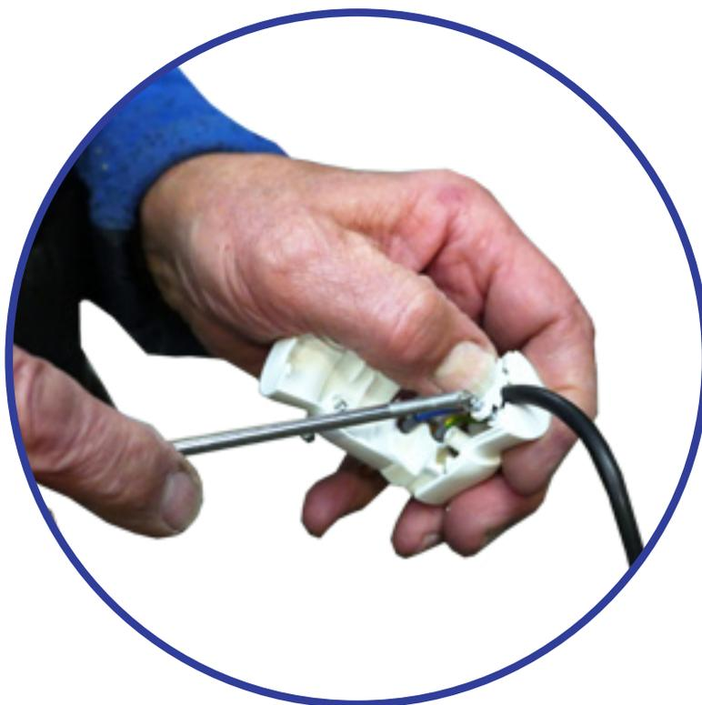
**Insérer les fils dans une prise électrique mâle 220 v**
